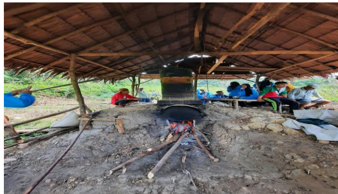
Gambar 4: Proses Pembakaran Daun Nilam Menjadi Minyak Atsiri
